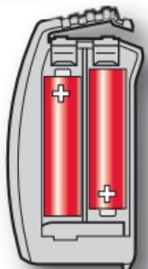
Installer des piles neuves lorsque l'avertissement de remplacement des piles **REPLACE BATTERY** commence à clignoter à l'écran. Ce message clignote pendant environ deux mois avant que les piles ne soient complètement épuisées.
