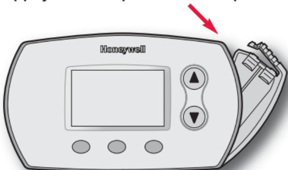
Insérer deux piles alcalines neuves de taille AA, puis remettre en place le porte-piles
