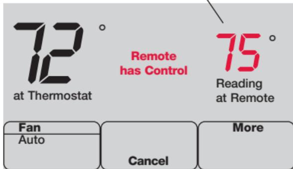
El control remoto opcional puede funcionar como termostato móvil para mantener una temperatura agradable mientras pasa de una habitación a otra.
